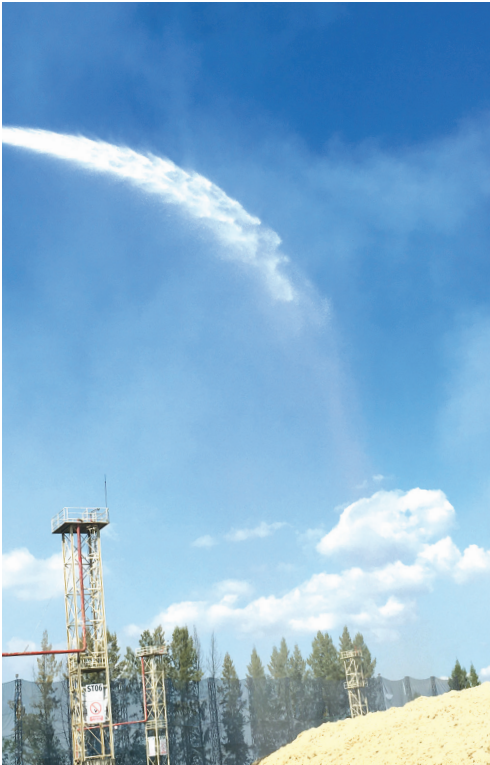
การควบคุมฝุ่นจากบริเวณจัดเก็บขามอ้อย เช่น สเปรย์น้ำเพื่อป้องกันการฟุ้งกระจายของขามอ้อย และติดตั้งที่ครอบสะพานลำเลียงขามอ้อย
